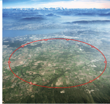
↑ Der LHC-Speicherring. Umfang 27 km. Im Inneren einer der kältesten (-271°C) und leersten ( 10^{-11} bar) Orte im Universum. (© 2001-2021 CERN)
