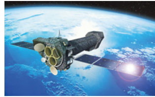
↑ XMM Newton, Röntgensatellit der European Space Agency, gestartet 1999, besitzt 3 x 58 ineinander geschachtelte Spiegel, Außendurchmesser je 70 cm. (Bild: ESA)
