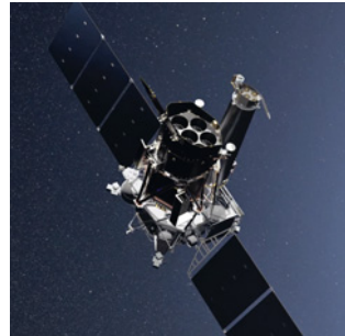
↑ XMM Newton, Röntgensatellit der European Space Agency, gestartet 1999, besitzt 3 x 58 ineinander geschachtelte Spiegel, Außendurchmesser je 70 cm. (Bild: ESA)
