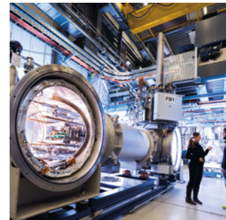
↔ Teststand für supra-leitende Ring-Magnete (Dipole).
