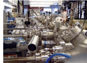
↑ In einer der weltweit größten Ultrahochvakuum-Anlage mit sechs Molekularstrahl-Epitaxie-Kammern können wir Kristallschichten aus vielen verschiedenen Materialien herstellen.
