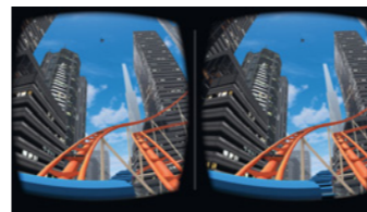
↑ Zwei Augen bestimmen die grundsätzliche Funktion aller VR-Systeme: Es werden zwei leicht versetzte Bilder benötigt, wobei eines davon auf das rechte, und eines auf das linke Auge fällt. (Quelle: https://play-lh.googleusercontent.com/8tGLVDliqqdUn-9NIBIWuJtfic_joGo-lpAxcR8UsQFoD99BbLIX7PDjABw4ZijOD-To=w1440-h620 )
