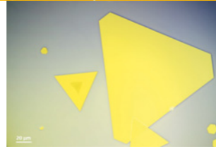
↑ Optische Mikroskop-Aufnahmen einer Goldflocke in Reflexion. Die Goldflocken sind weniger als 50 Nanometer dick und teilweise über 100 Mikrometer groß.
