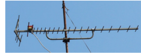
↑ Eine Yagi-Uda-Antenne zum Empfang von Radiowellen im Frequenzbereich von etwa 100 MHz. (Quelle: Mk2010, CC BY-SA 3.0)
