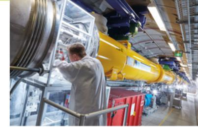
↑ In supraleitenden, mit Helium auf -271° Celsius gekühlten Beschleunigermodule werden Elektronen auf annähernd Lichtgeschwindigkeit und hohe Energien von bis zu 17,5 GeV beschleunigt.
