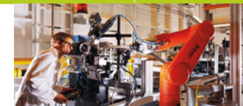
↑ Zur Untersuchung von biologischen Proben setzt ein Roboter mit hohem Durchsatz in flüssigem Stickstoff gekühlte Proteinkristalle in die Messstation ein. An dieser PETRA III-Messstation sind so beispielsweise zwei vielversprechende Kandidaten für Corona-Medikamente entdeckt worden.
