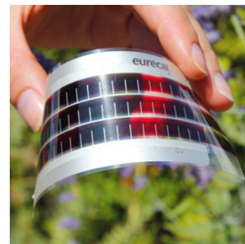
↑ Organische Solarzelle zur Untersuchung im Labor. Sie können kostengünstig und in großen Mengen als flexible PV-Elemente hergestellt werden.
