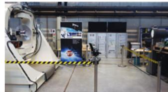
→ Um die Bewegung der Satelliten und die resultierenden Effekte präzise auf der Erde zu simulieren, werden zwei hoch-dynamische Drehtische in Kombination mit einem Sonnensimulator am ZfT eingesetzt. (Quelle: S4)
